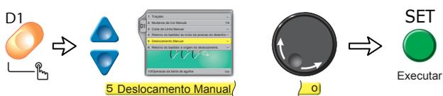
⚡ Voltar bastidor para a posição anterior depois de mover bastidor
